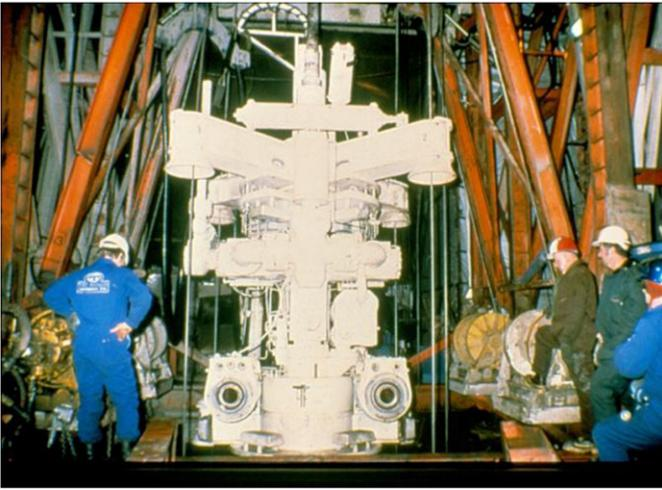
Fig. 37. Wellhead inside the rig.
